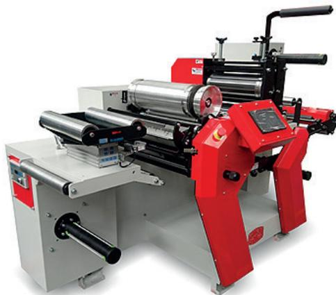
La Fastrack F350 è il nuovo sistema di rifinitura semirotativo, sviluppato per il settore della stampa digitale per etichette. La Fastrack F350 permette la laminazione, la verniciatura e la fustellatura di etichette stampate in bobina con la maggior parte dei sistemi di stampa digitale attualmente in commercio.
