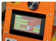
La Mini Fastrack 220 è dotata di un pannello touchscreen LCD che permette all'operatore di avviare la produzione ed effettuare regolazioni di posizionamento in tempo reale.
