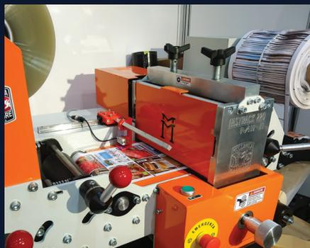
Nuovo sistema di rifinitura semirotativo compatto con possibilità di utilizzo anche in modalità rotativa. Display touchscreen da 7 pollici. Fustellatura attraverso utilizzo di lamierini flessibili. Controllo di registro con lettura tacca nera tramite sensore laser. Modulo di laminazione protettiva a freddo, senza liner.
