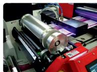
La Fastrack F350 permette, mediante l'utilizzo di un cilindro magnetico semirotativo ad impulsi e un'unità di verniciatura UV, di rifinire e fustellare le vostre etichette stampate in bobina
